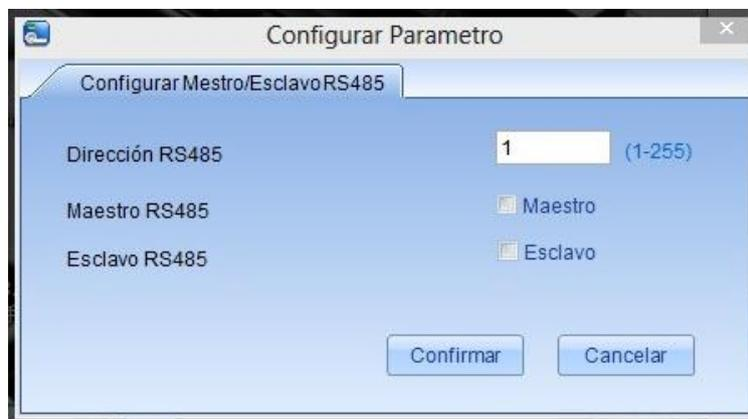
1. Dirección RS485: Configure el número del equipo. Es equivalente a la dirección IP de Ethernet pero usando RS485. Es la única opción para establecer un puerto de comunicación serial. El rango será de 1-255.
