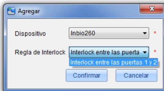
2. Seleccione el equipo. Cada equipo podrá soportar una función de interlock si tiene el equipo ya agregado los sub equipos conectados a él podrán ser visualizados en la lista. Cuando borre una configuración de interlock ya establecida el equipo regresará a la lista despegable. La página de configuración varía de acuerdo a las puertas del equipo seleccionado:
